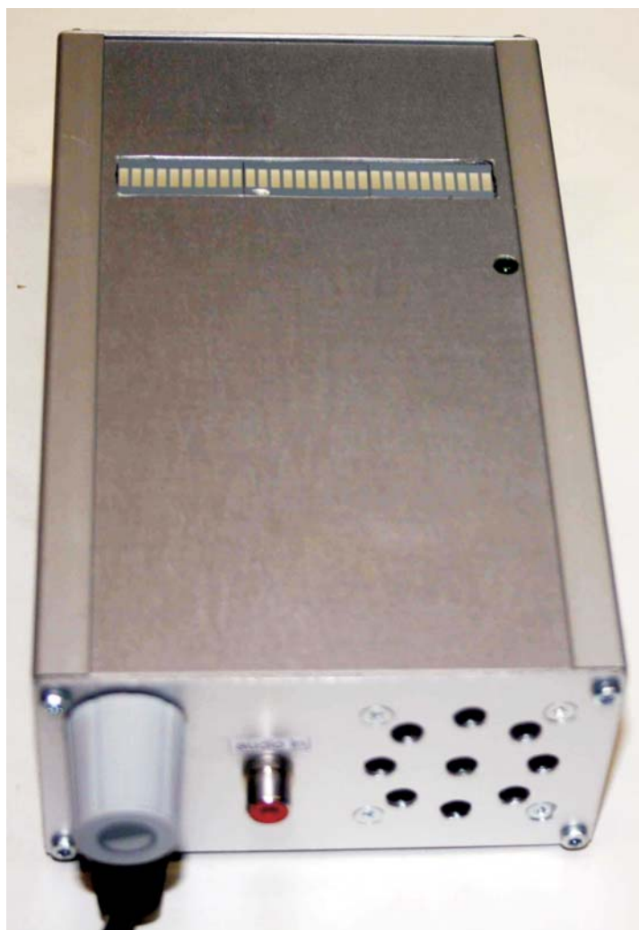
Η συσκευή MSIA έτοιμη για χρήση. Η οθόνη LED είναι στο πάνω μέρος, η πράσινη LED Aldis από κάτω και δεξιά της, ενώ το μεγάφωνο είναι εμπρός, μαζί με το κονέκτορ RCA για το σήμα εισόδου και το ποτενσιόμετρο volume.
